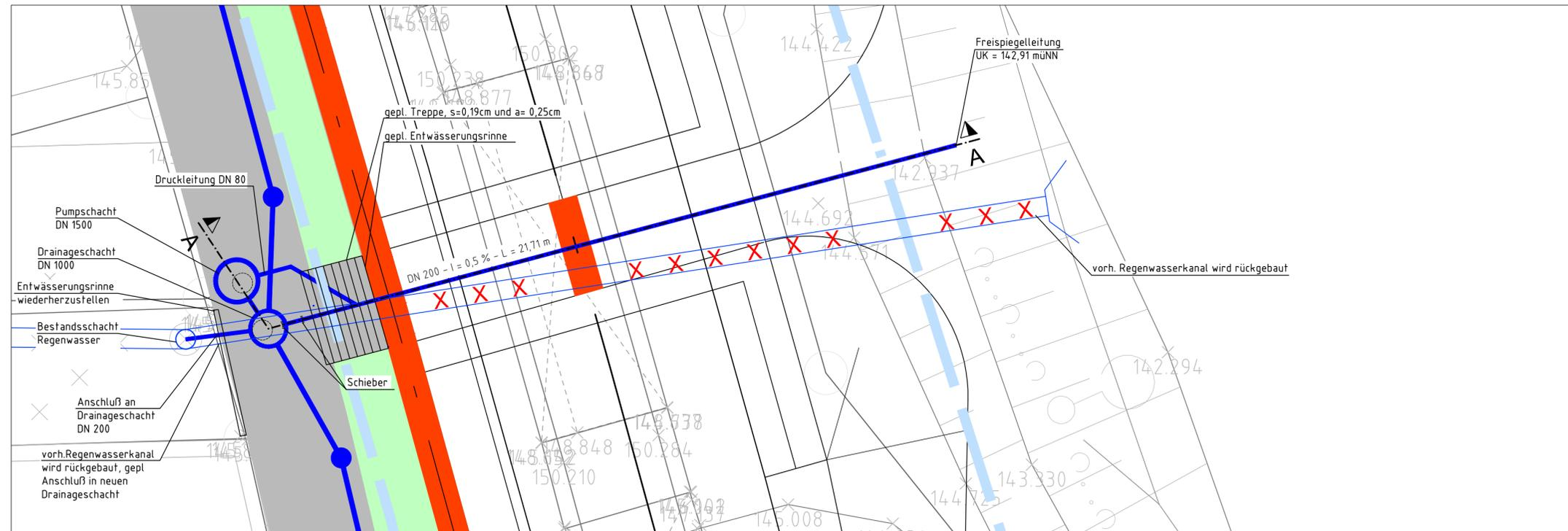
Herstellung dichter Anschluss (Lehmplombe, Dichtungsring) sämtlicher Leitungsquerungen im Bereich der Dichtwand.
